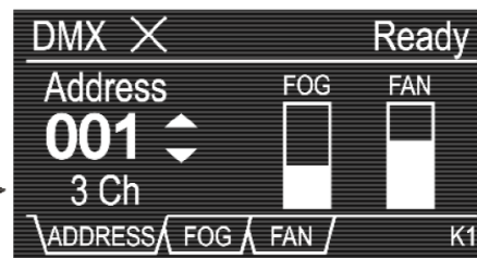
Figuur 7 - DMX aansturing hazer
